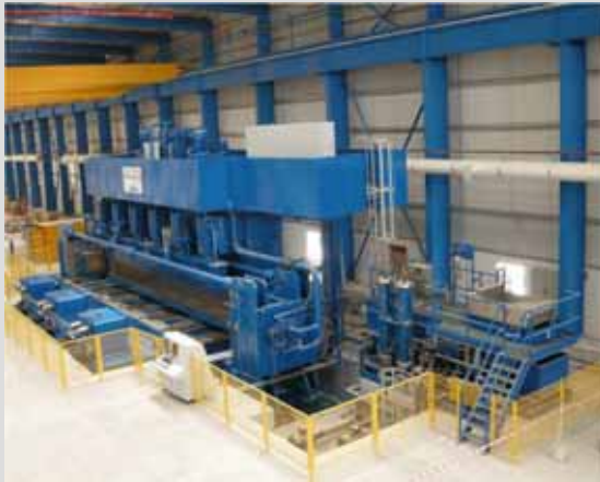
HFC 380, mit 380.000 kN, für 12 m Rohre
