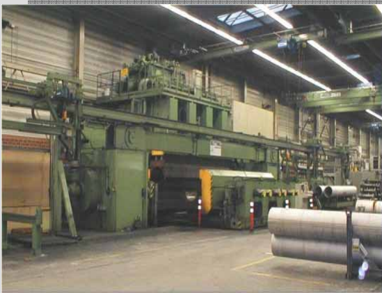
HFC 320, mit 320.000 kN, für 6 m Rohre
