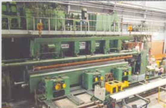
HFC 240 mit 240.000 kN, für 12 m Rohre
