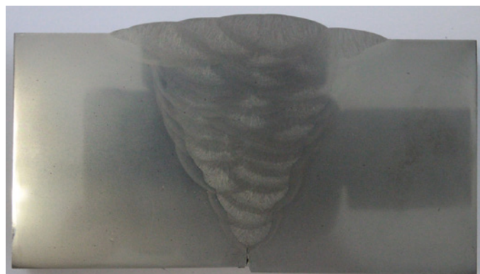
Эталонный сварочный процесс с 3-я проволоками
